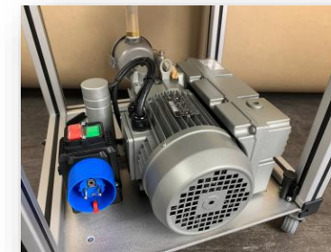
Becker Vakuumpumpe 20 m³/h
