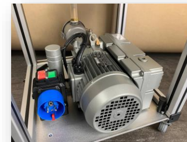
Becker Vakuumpumpe 20 m³/h
