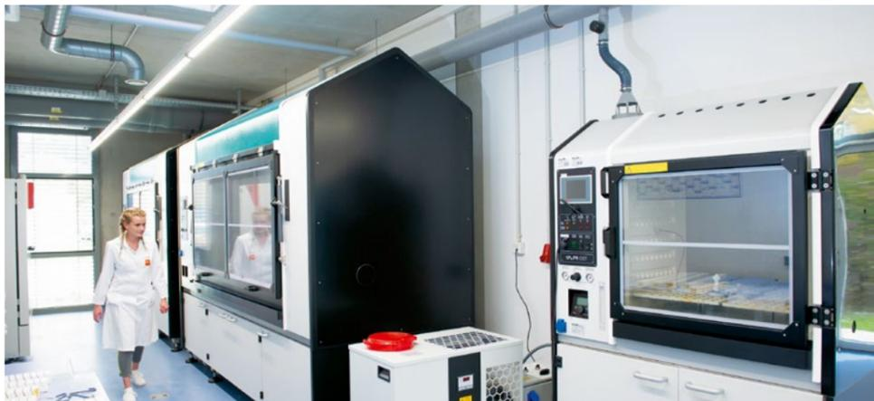
Das IFO-Labor ist mit unterschiedlichen Korrosionsprüfkammern ausgestattet. Dadurch kann der Dienstleister auf kundenspezifische Bauteilanforderungen eingehen und Korrosionsprüfungen entsprechend der Größe der Bauteile oder dem benötigten Volumen anbieten. Fotos: IFO
