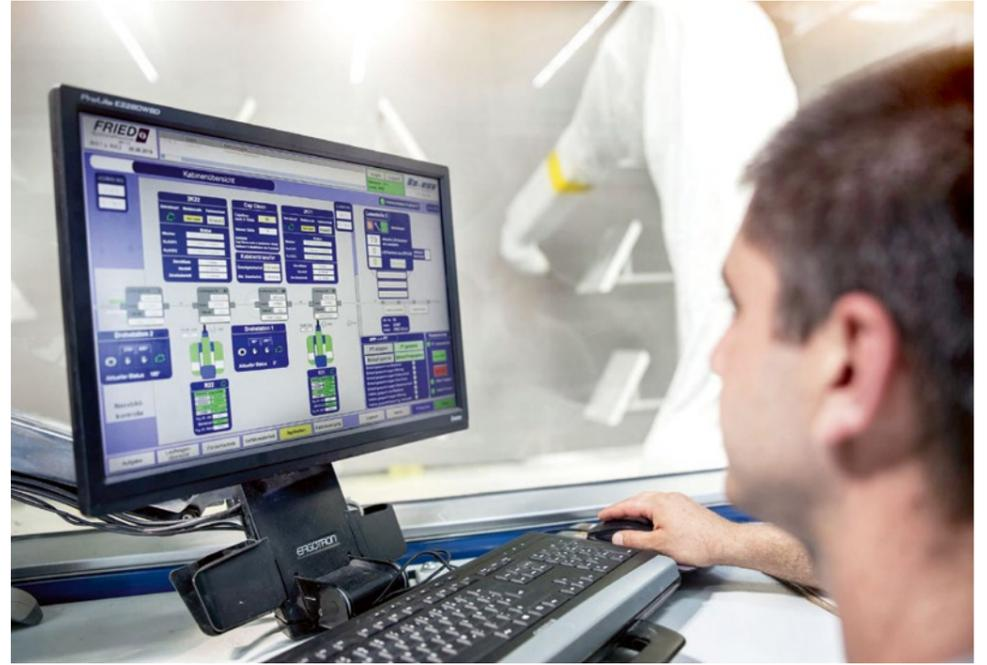
Sämtliche Prozesse der vollautomatischen Lackieranlage können die Verantwortlichen detailliert am Bildschirm nachverfolgen.
