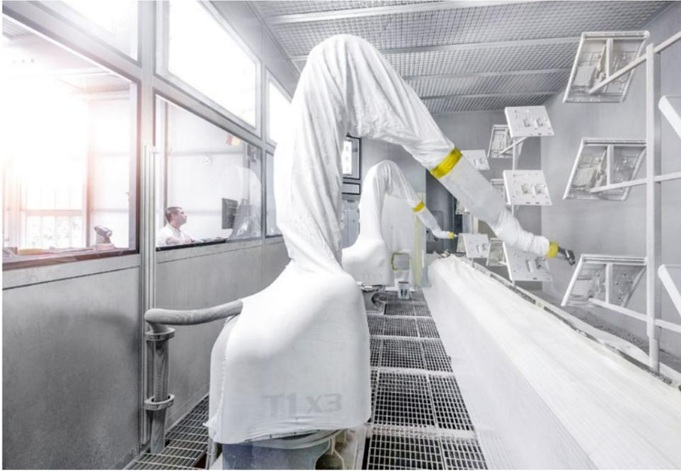
Die Beschichtung erfolgt mit zwei Lackierrobotern des Typs „T1 X5“, 2K-Misch- und Dosiertechnik und einer energiesparenden Trockenabscheidung.
