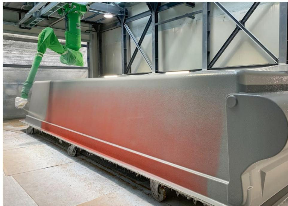
Der Roboter kann hängend das komplette Bauteil beschichten.
