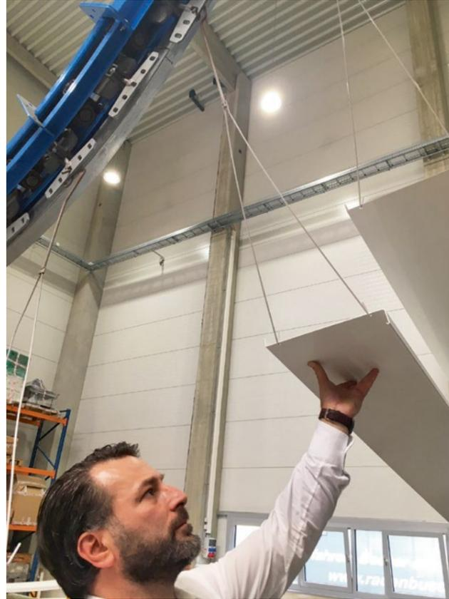
Mit den Haken kann Color/G zehn breite Profile auf 2 m Kettenlänge fahren, hier bei der Kontrolle durch Produktionsleiter Kostas Tzelepis.
