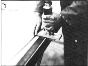
Fräsen des Formenrandes Milling of mould rim
