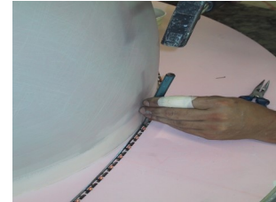
Fixierung mit kleinen Nägeln am Modell Fixing of steel edge to the model with small nails
