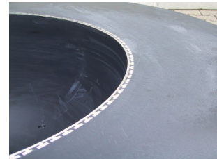
Fertiger Formenrand mit Stahlkante Finished mould with steel edge
