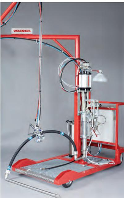
Faserspritzen ist das wirtschaftlichste offene Verfahren. Sparen Sie bis zu 30% Zeit im Vergleich zum Handlaminat, und dabei sparen Sie durch den Einsatz von Roving auch bei den Verstärkungsmaterialien. Die Faserspritzanlagen von Wolfangel haben einen minimalen Overspray beim Spritzen und können auch gefüllte Harze und Formenbauharze verarbeiten.
