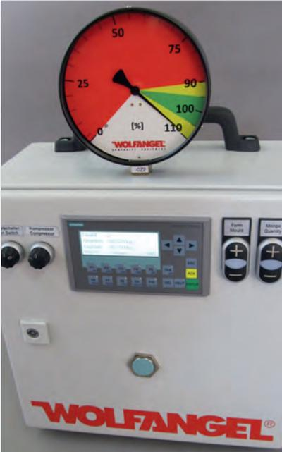
Die pneumatische Mengenfortschrittsanzeige unterstützt den Mitarbeiter beim Spritzen der korrekten Menge Gelcoat oder Glas und Harz beim Faserspritzen. Die Fortschrittsanzeige ist mit RFID ausgestattet und ermöglicht damit einfach und sicher die Erkennung der zu belegenden Form. Der Mitarbeiter erkennt an einem Display in seinem Sichtbereich den Fortschritt des Spritzvorgangs.
